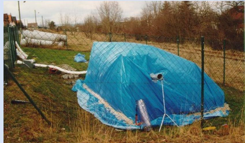
Kleinkläranlage mit definiertem Luftwechsel
